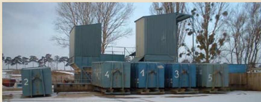
Automatska pretovarna stanica u Budimpešti. U svaki kontejner se uprešava pojedina sirovina. Izmjenjivi rollkontejneri od 27 m 3 puni komunalnog otpada mogu težiti i preko 20 t
