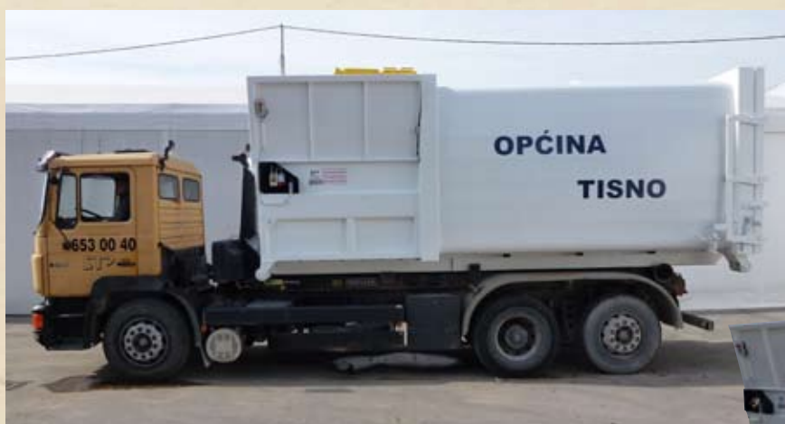
RM-20 sa čvrstim pretovarnim grotlom u Općini Tisno vrši funkciju mini pretovarne stanice u koju se pretovaraju kamioni koji prazne sustave MOLOK
